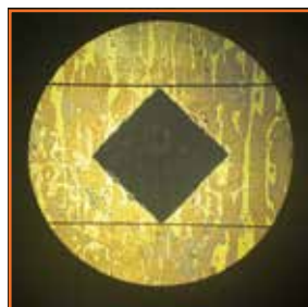
Odcisk przy próbie Vickersa
