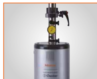
Wzorczenie przy użyciu dodatkowego uchwytu do czujników dźwigniowo-zębatych (typu poziomego)
