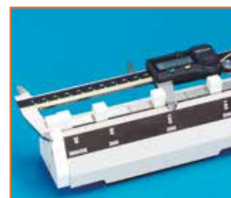
Sprawdzenie dokładności suwmiarki (pomiar wymiarów zewnętrznych)
